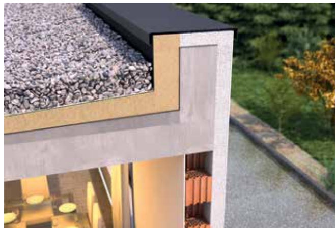
Przekrój dachu płaskiego balastowego
