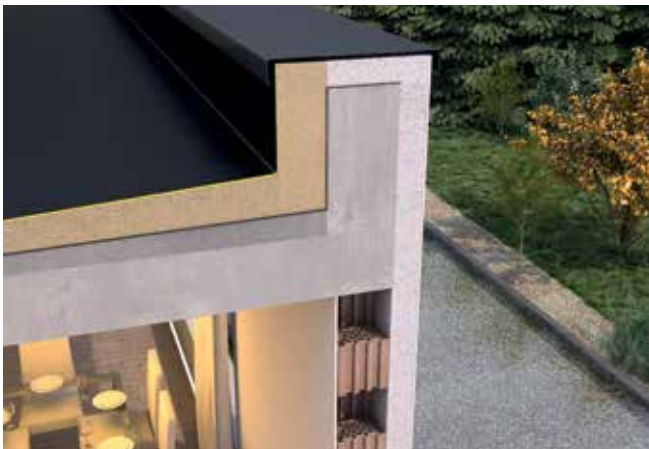
Przekrój dachu płaskiego
