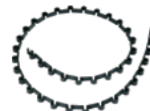
Mocowanie przewodów grzejnych w rynnach kwadratowych
